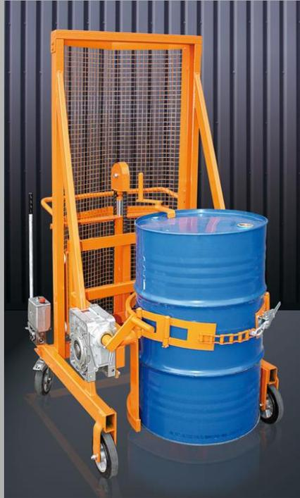
Massive konstruierter Handwagen zum Transportieren, Kippen und Drehen von Sicken-Fässern. Die Fässer werden von Stahlriemen mit Exzenterverschluss gehalten. Der Kippvorgang wird mittels Kettenrad, Handkurbel oder hydraulisch betätigt.
